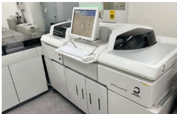
生化学自動分析装置：1時間に2400項目測定できる分析装置です。2台で生化学の検査を行っています。
