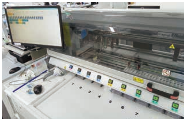
搬送システム：検体をどの分析装置で測定するかを判断し、分析装置まで運んでくれます。
